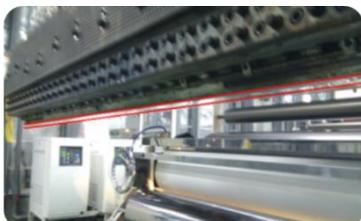
酯系透濕防水薄膜試量化生產過程
