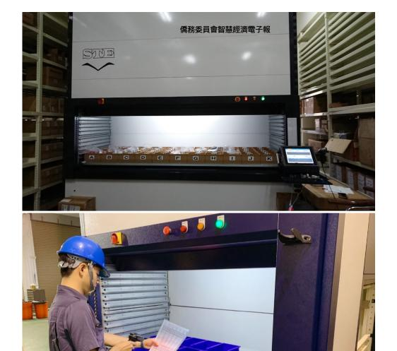
鈞曜科技開發出自行製造的垂直式和旋轉式倉儲解決方案,以拖盤為單位、多種規格的標準化尺寸,依客戶需求與規格,設計與拼接出像積木一樣客製化與彈性的智慧倉儲,在設備面向:鈞曜的智慧倉儲設備水平、垂直、旋轉式升降都不是問題,密閉空間可避免塵照,具備單一操作口提升安全性;在操作面向:鈞曜科技提倡「貨到人」的概念,操作員以帳密管理存貨、拿貨,每次的操作、規格與品項,會自動被系統儲存,系統並在下次操作時會自動調整規格,再者,鈞曜科技的智慧倉儲管理系統,透過智慧装置與設備上的面板,讓客戶即時掌握整個倉儲場域與各個設備的物料狀況、產品進出記錄、並可追蹤與分析歷史數據。
